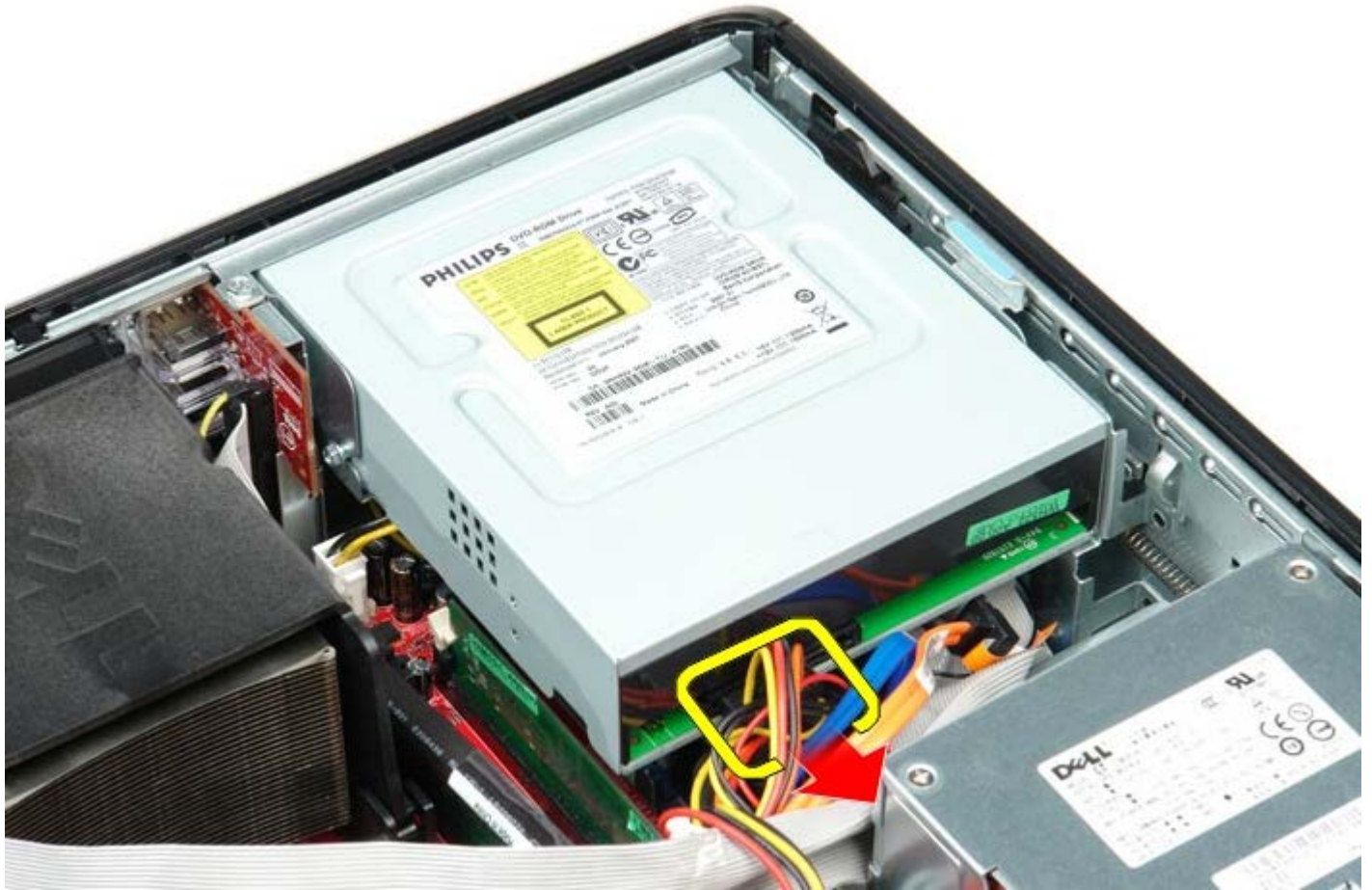
1 11 提起驱动器释放闩锁，并朝计算机背面滑动驱动器。
