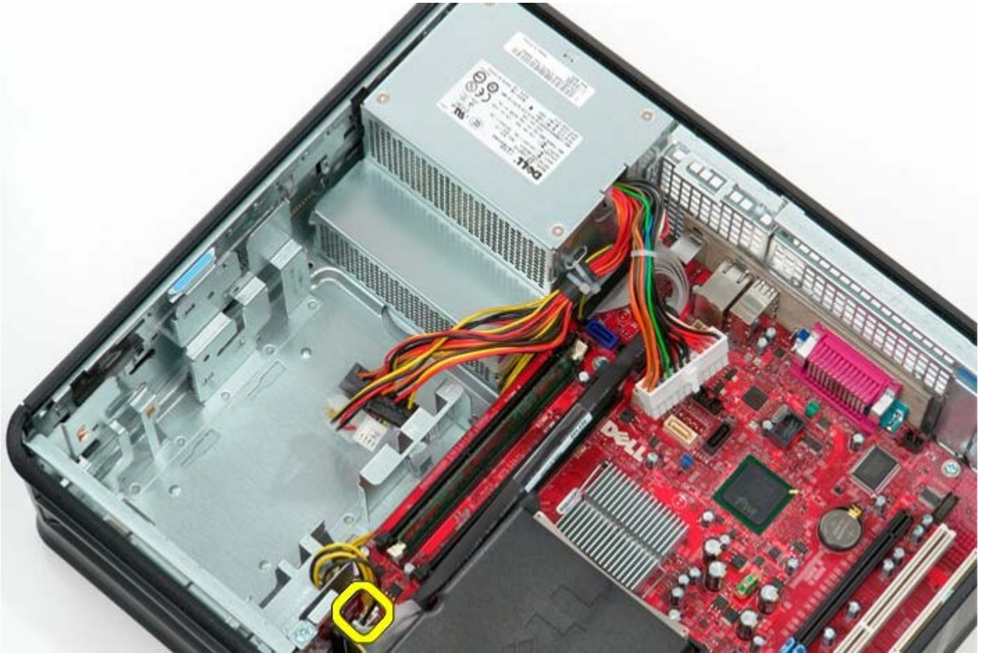
1 11 通过系统板下的布线导轨释放处理器电源连接器电缆。
